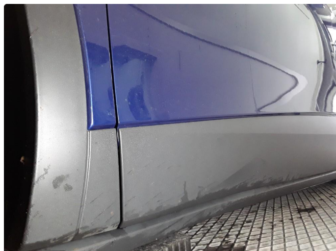
1.2 Liten steinsprut med korrosjon venstre fordør.
