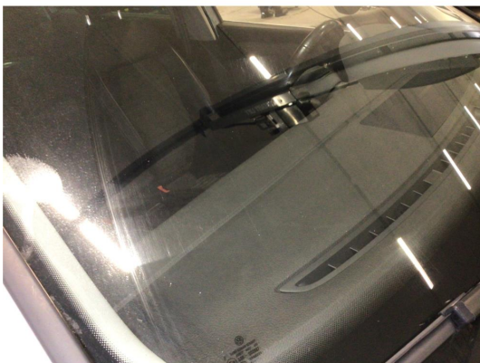
1.3 Slitasjeriper og noe steinsprut på frontvindu
