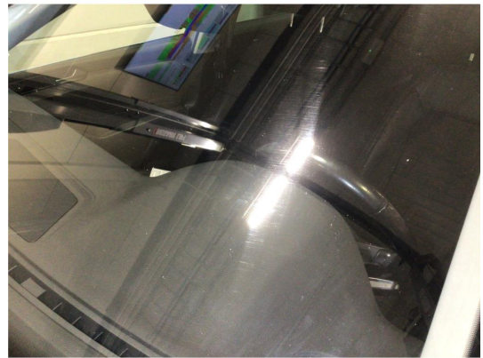
1.3 Slitasjeriper og noe steinsprut på frontvindu
