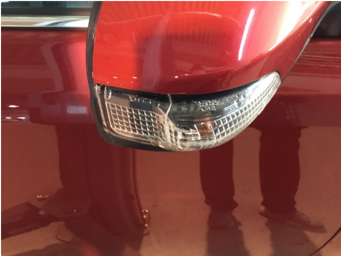
1.1 Sprekk i glass
