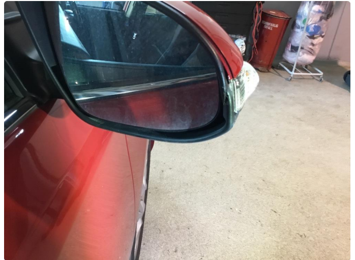
1.1 Sprekk i glass
