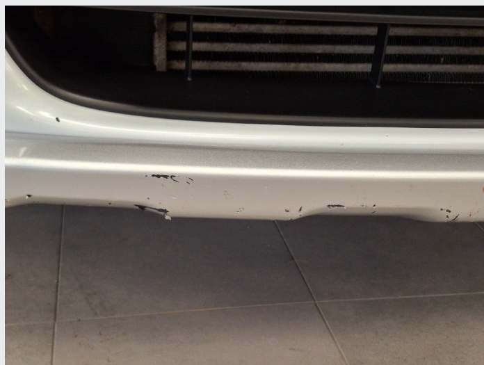
2.8 Merker/hakk nederst på støtfanger foran.
