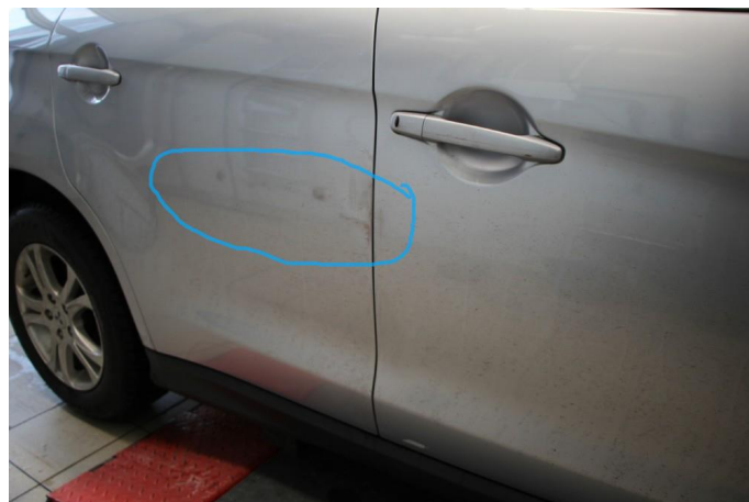
1.3 Knekk i bakkant av dør foran og større bulk i dør bak
