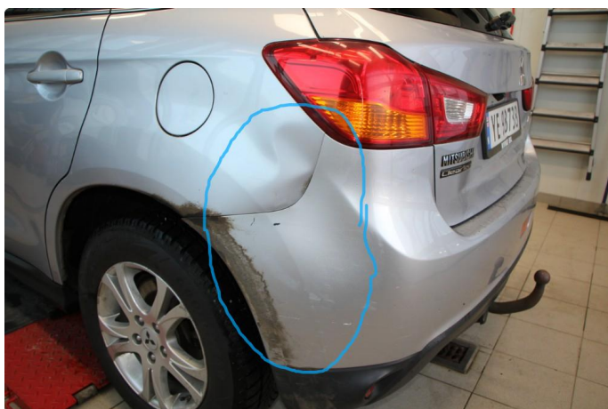
1.5 Skade i skjerm og støtfanger.
