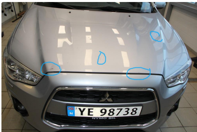
1.2 Knekk 2 plasser i forkant av panser, den ene med rust. Flere små bulker i panser.
