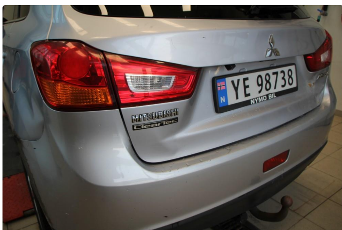
1.4 Flere store bulker, noe rust også
