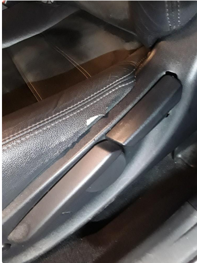
2.1 Skade på setetrekk
