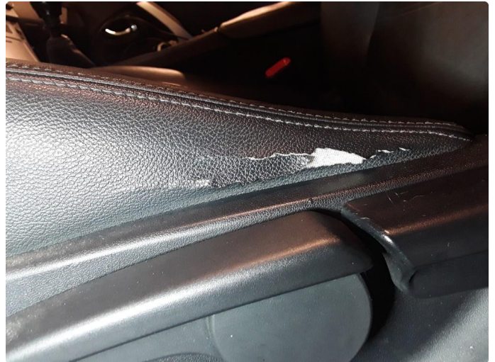
2.1 Skade på setetrekk
