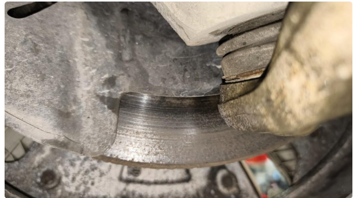
2.1 Noe rust, men ikke EU-feil
