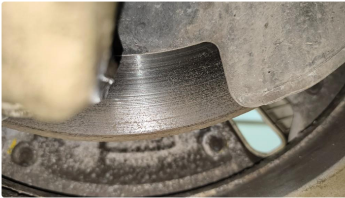
2.1 Noe rust, men ikke EU-feil
