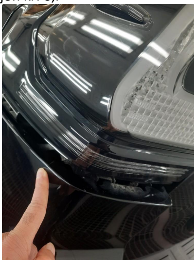
1.3 Sprekk i støtfanger bak v side.
