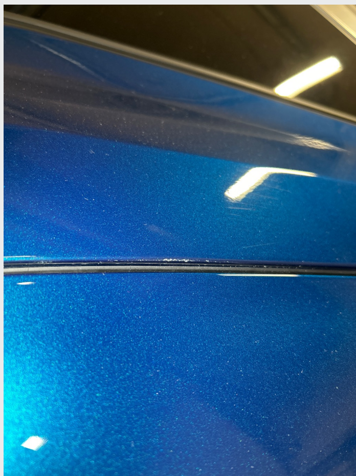
2.1 Noe riper og steinsprut rundt om
