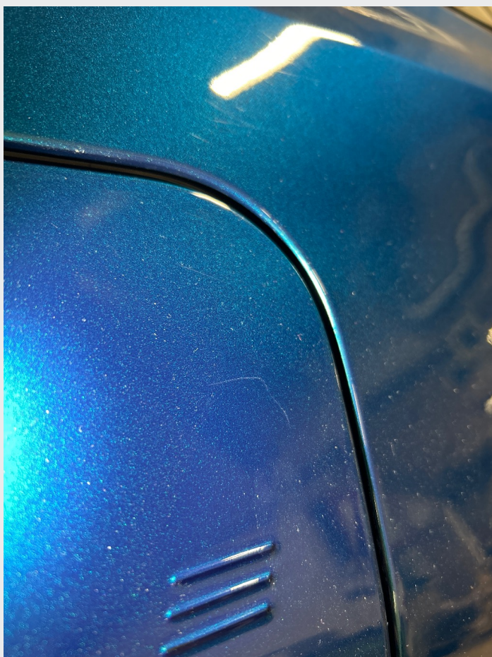
2.1 Noe riper og steinsprut rundt om
