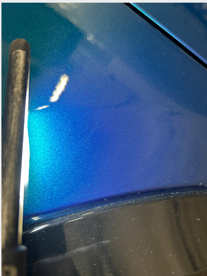
2.1 Noe riper og steinsprut rundt om
