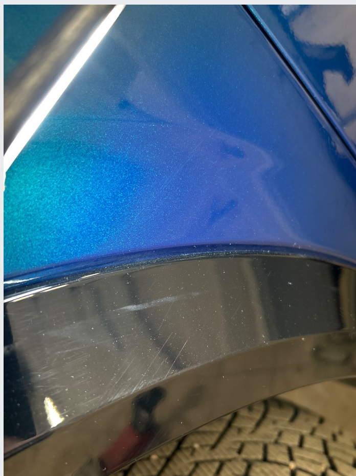
2.1 Noe riper og steinsprut rundt om
