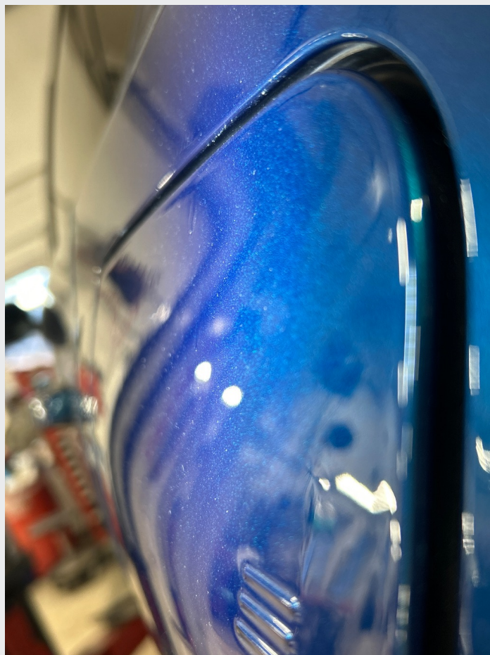
2.1 Støv og sig i lakk på ladeluke
