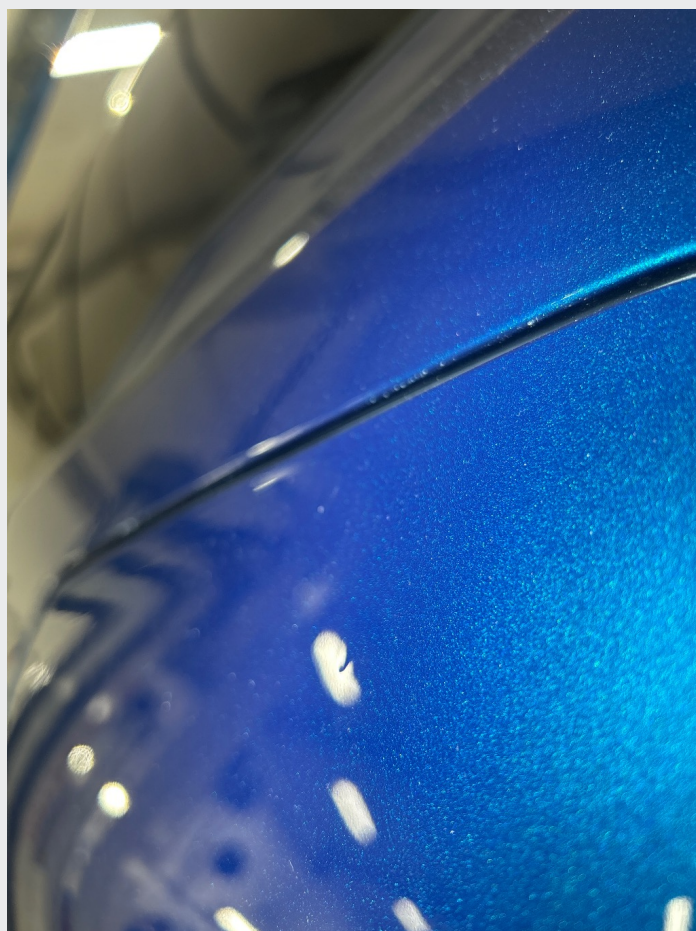
2.1 Støv og sig i lakk på ladeluke
