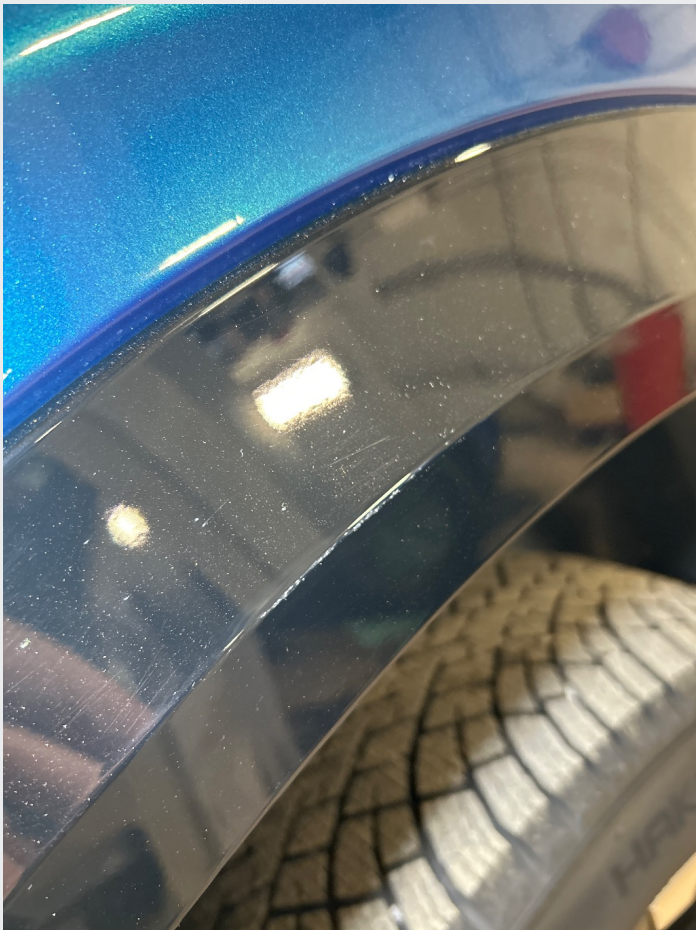
2.1 Noe riper og steinsprut rundt om
