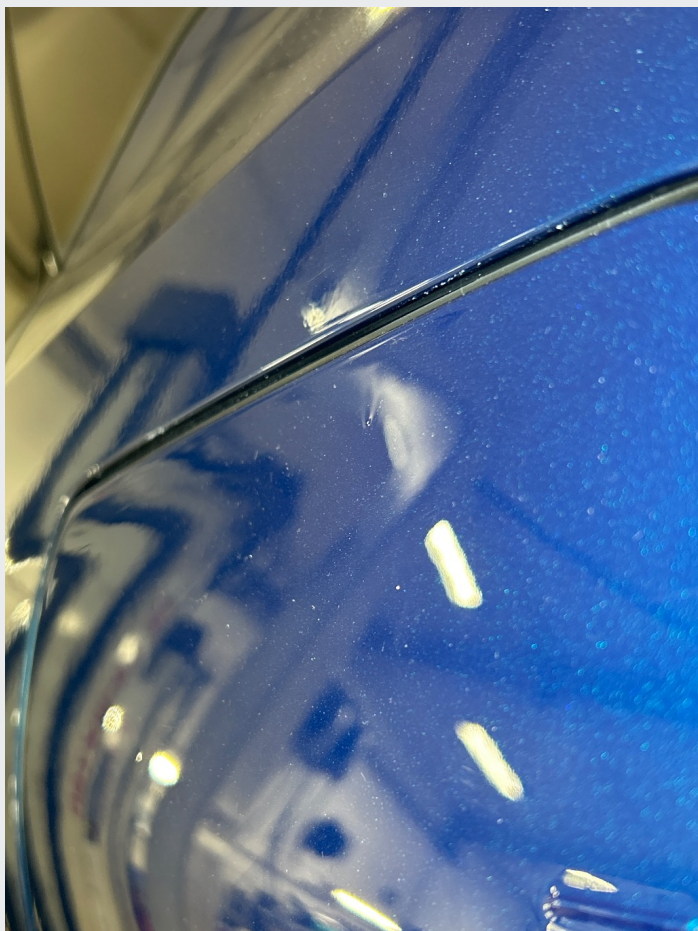
2.1 Støv og sig i lakk på ladeluke
