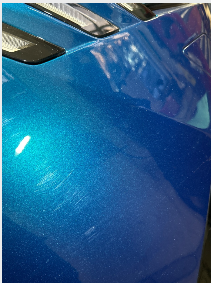
2.1 Noe riper og steinsprut rundt om
