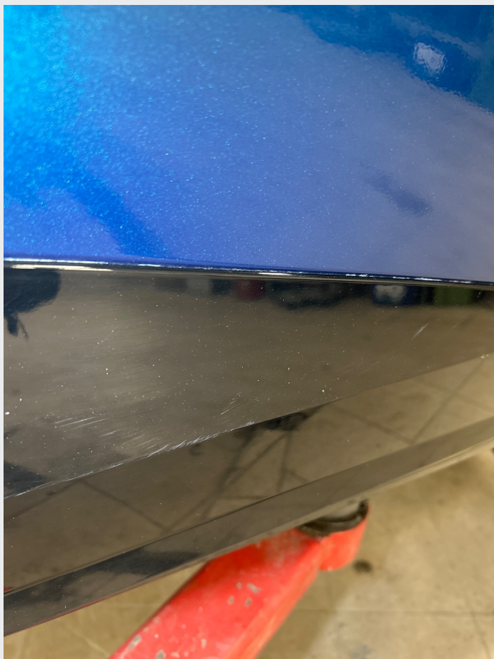
2.1 Noe riper og steinsprut rundt om
