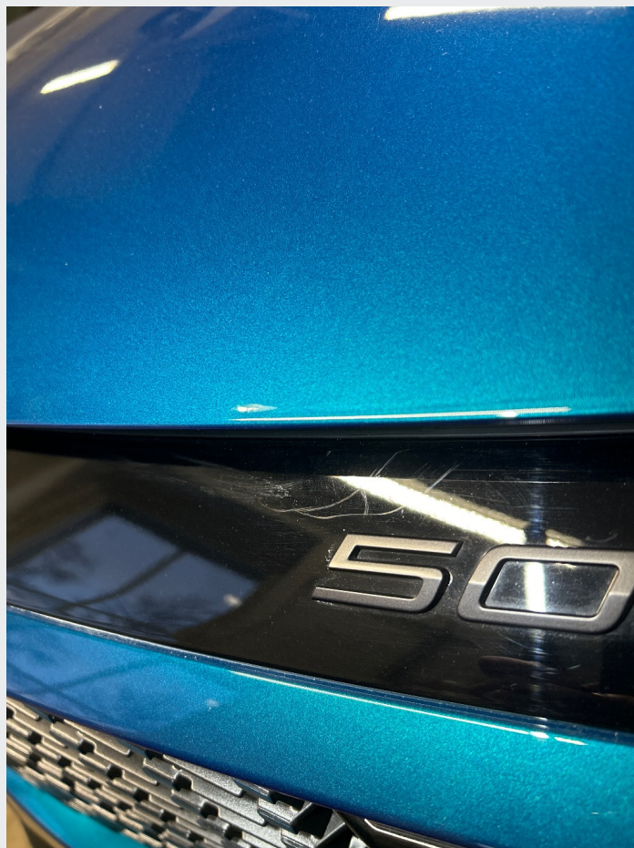
2.1 Noe riper og steinsprut rundt om
