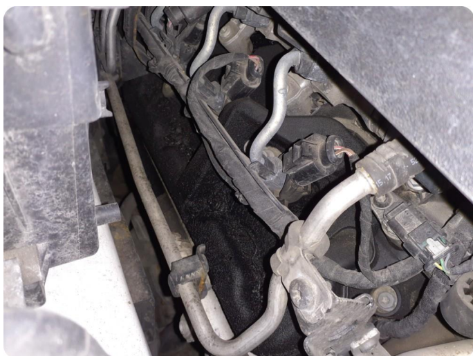
5.2 Svetter Motor svetter flere steder. Må kontrolleres
