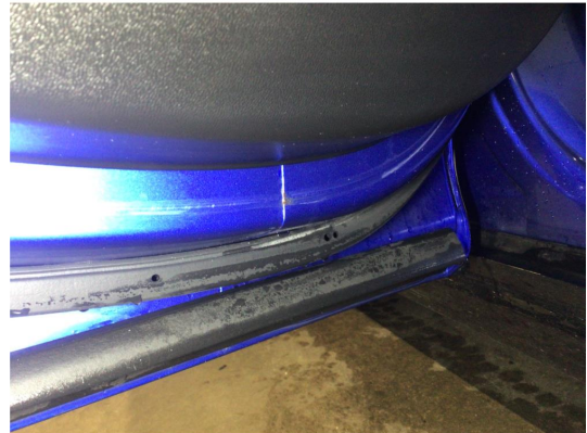
1.1 Litt korrosjon på innside av dører, dette av ubetydelig karakter
