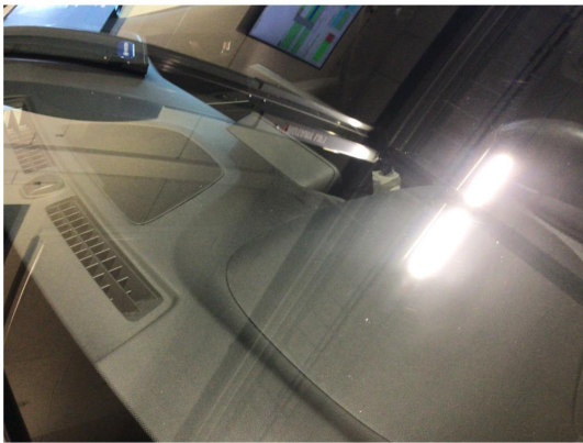
1.2 Noe steinsprut på frontvindu
