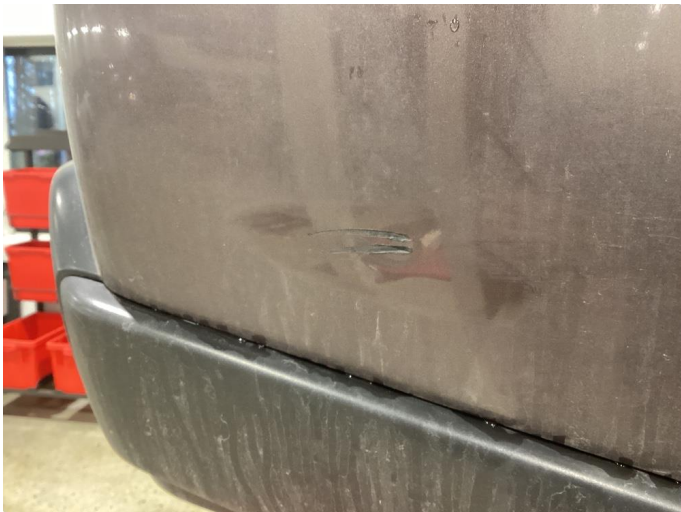
1.2 Ripe(r) ned til grunning
