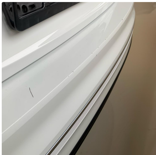
1.2 Noe sår og riper på støtfanger bak.
