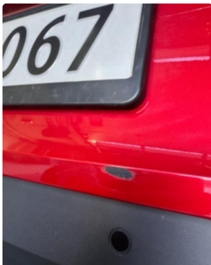
1.2 Noe riper høyre foran og midten bak. Blir penslet.
