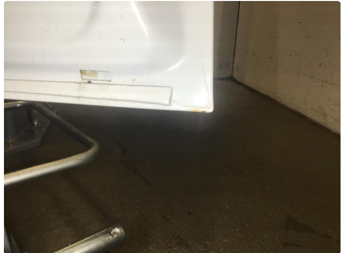
1.1 Små korrosjonsflekker i nedre kant på begge framdører, dette av ubetydelig karakter
