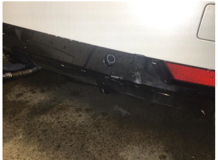
1.3 Små hakk/riper på bakfanger høyre side, dette blir å anse som normal bruksslitasje
