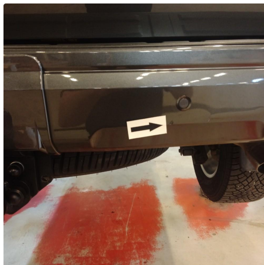
1.1 Bulk med lakkskade. MINDRE KOSMETISK ANMERKNING, LAKKSTIFT BENYTTET.
