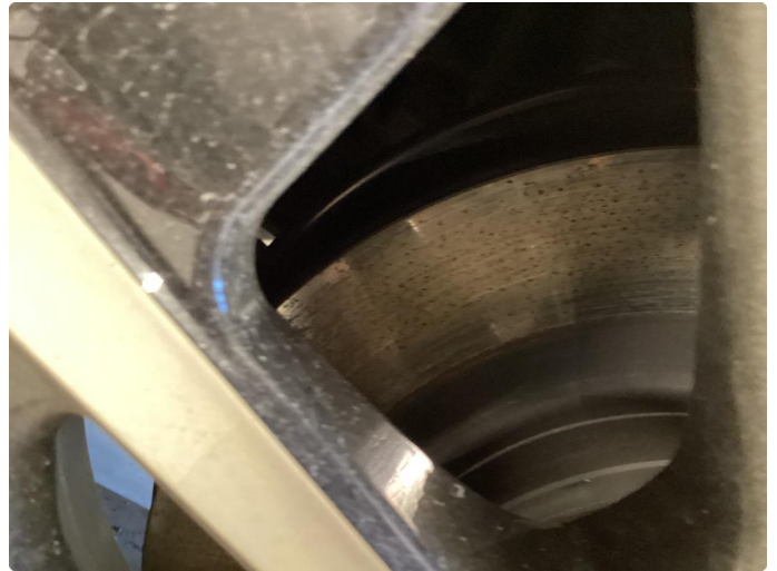
1.1 Overfladisk rust på skiver foran og bak. KJØRES RENE NÅR BILEN TAS I BRUK
