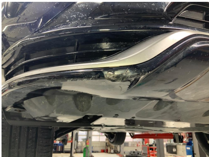
1.1 Skrubbskader underkant. UTBEDRINGER UTFØRT PÅ KLARGJØRINGEN + LAKKSTIFT BENYTTET.
