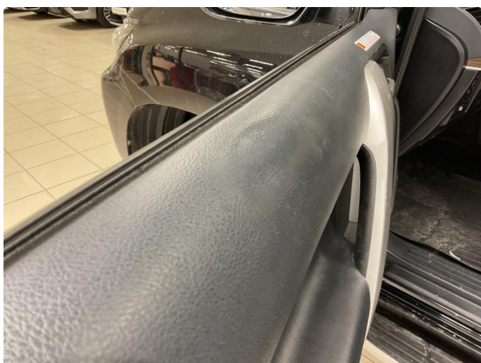
2.1 Små Merker i Dør Trekk VF
