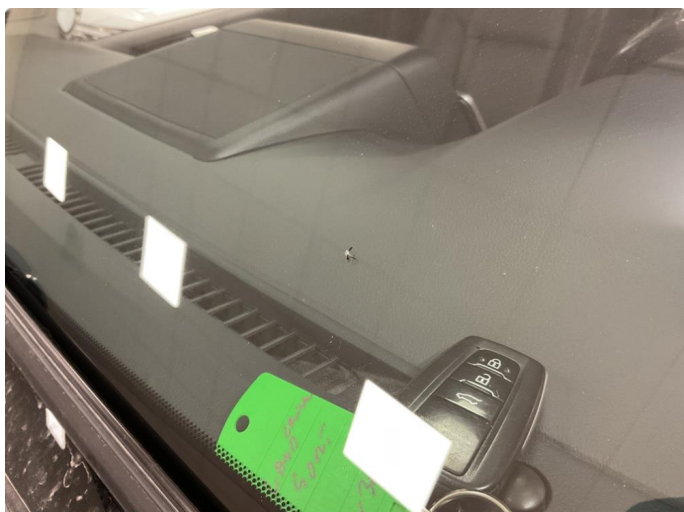
1.1 Liten stein sprut skade i Front Rute.
