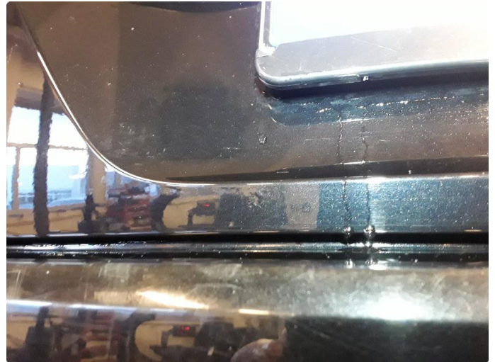
1.3 Liten steinsprut med korrosjon.
