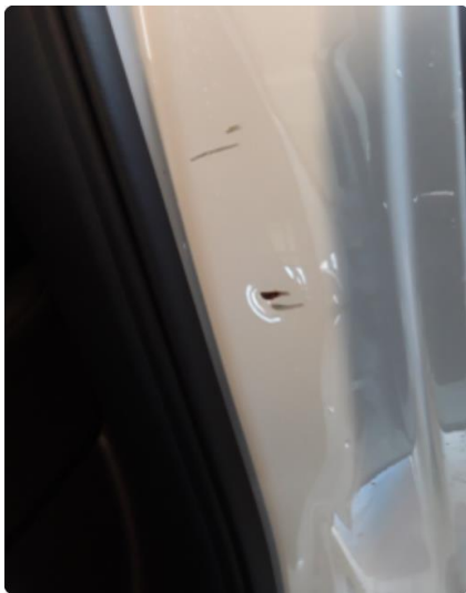
1.4 Liten bulk med lakksår venstre bak.
