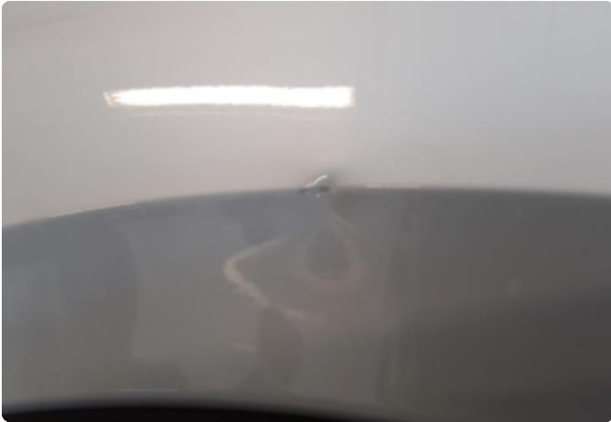
1.2 Liten bulk høyre forskjerm. Blir forsøkt med bulkfix.
