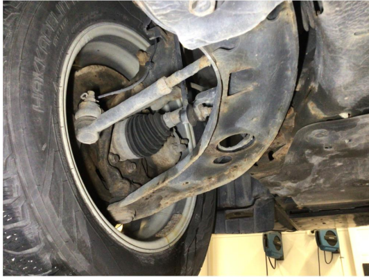
2.1 Overflaterust i forstilling, ingen tiltak kreves
