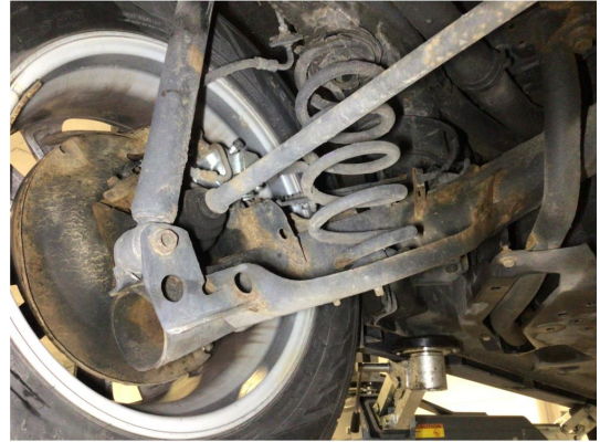
2.2 Overflaterust i bakstilling, ingen tiltak kreves
