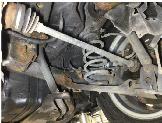
2.2 Overflaterust i bakstilling, ingen tiltak kreves
