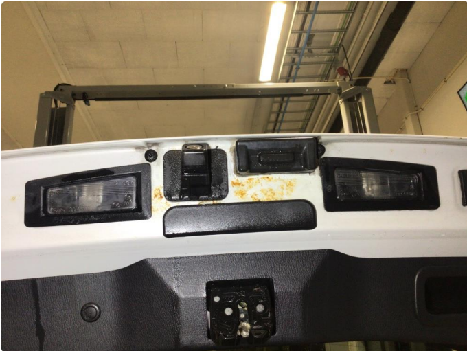
1.1 Noe overfladisk korrosjon på innside av bakluke
