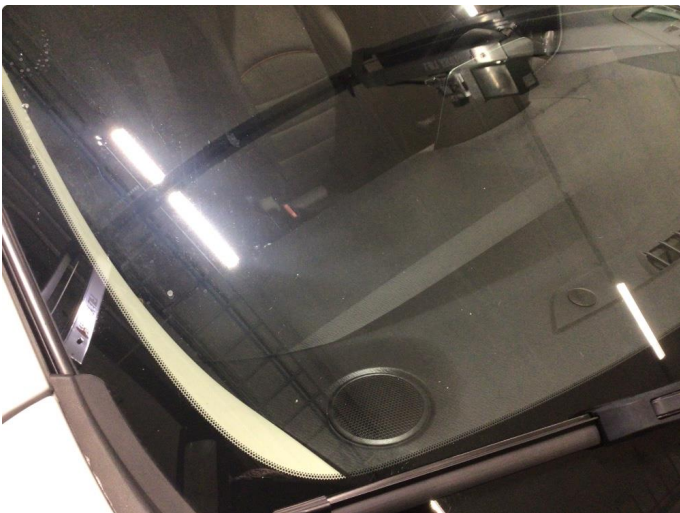
1.4 Noe steinsprut på frontvindu
