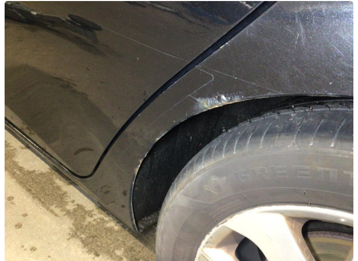
1.1 Rust/korrosjon i venstre bakskjerm
