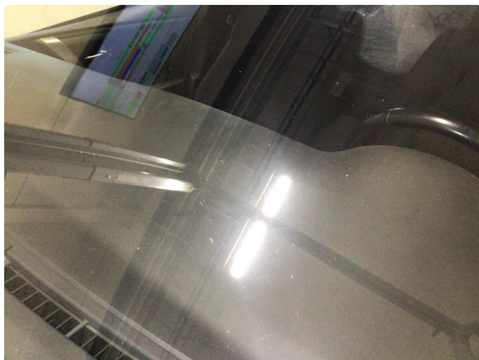
1.4 Noe steinsprut på frontvindu
