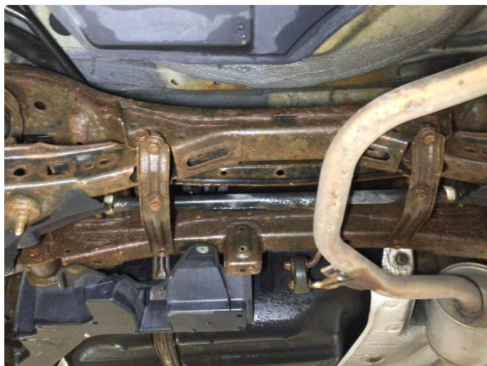
2.2 Overflaterust i bakstilling, ingen tiltak kreves
