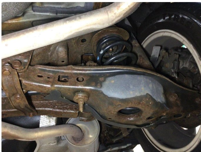
2.2 Overflaterust i bakstilling, ingen tiltak kreves
