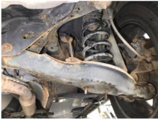
2.2 Overflaterust i bakstilling, ingen tiltak kreves
