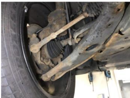
2.1 Overflaterust i forstilling, ingen tiltak kreves
