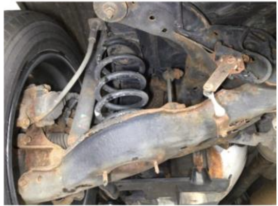
2.2 Overflaterust i bakstilling, ingen tiltak kreves
