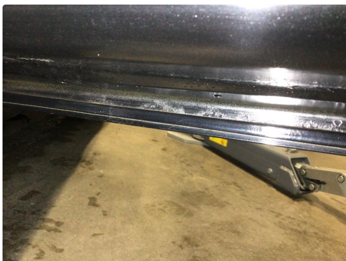
1.1 Noe korrosjon på innsiden av dører, dette av veldig liten betydning
