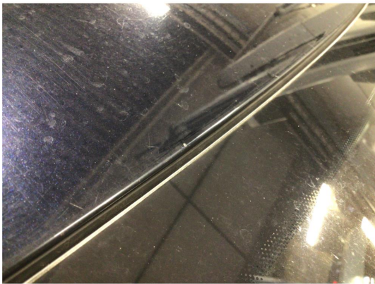
1.3 Noe steinsprut på tak
