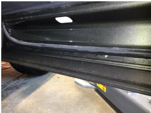
1.1 Korrosjon ved fals på begge framdører og høyre bakdør
