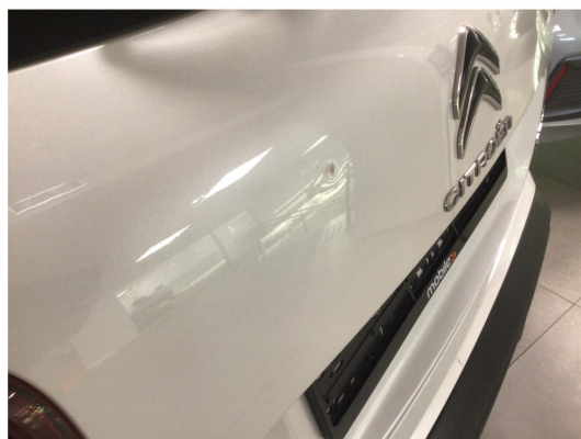
1.1 Liten bulk på bakluke blir utbedret med smart repair
