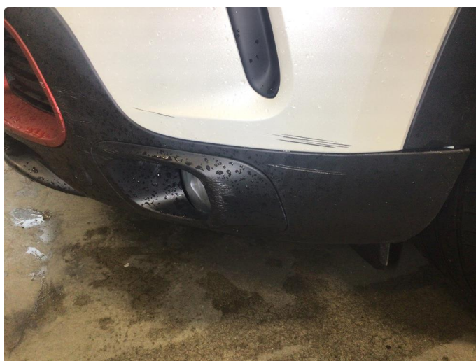
1.3 Noe riper på venstre side av frontfanger blir utbedret med pensellakk
