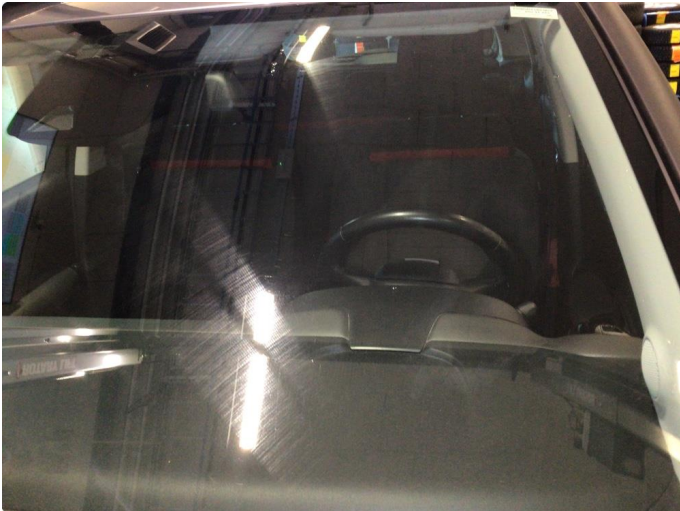
1.1 Noe slitasjeriper på frontvindu
