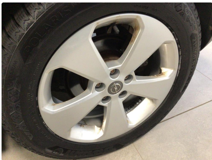
1.2 Noe oksidering på to vinterfelger
