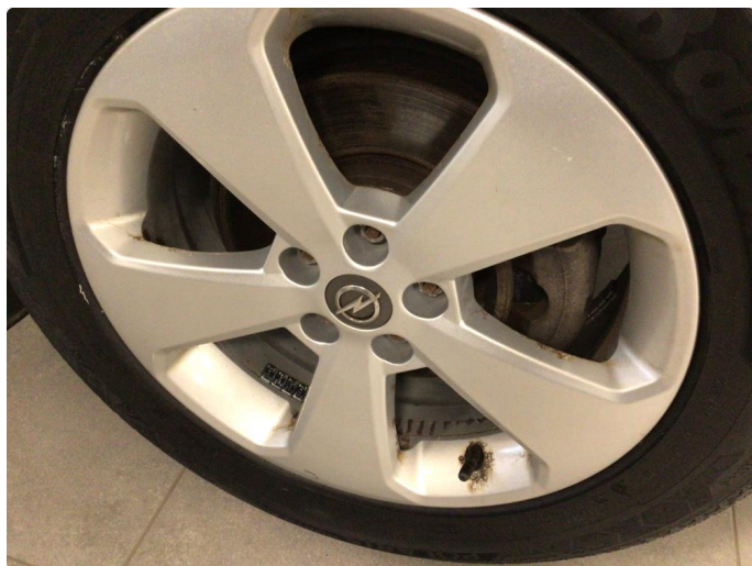
1.2 Noe oksidering på to vinterfelger
