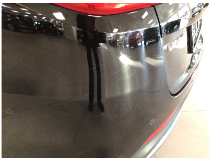
1.3 Noe riper på bakfanger venstre side, dette anses som normal bruksslitasje
