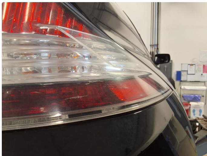
2.1 Noe krakelering i høyre baklykt
