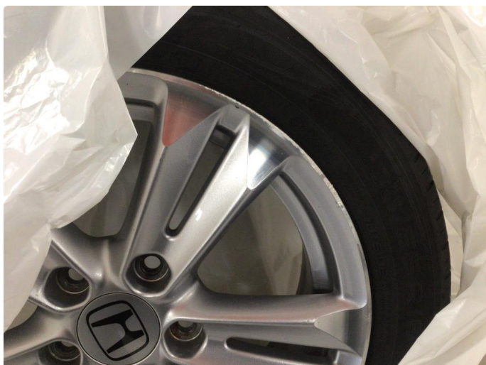
1.1 Kantkjørt en sommerfelg og en vinterfelg, samtlige vinterfelger er oksidert
