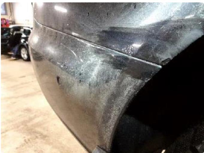
1.3 Noe rustbobler under lakk. Begge hjulbuer bak
