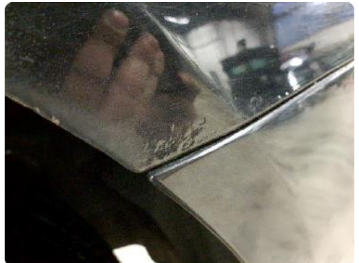
1.3 Noe rustbobler under lakk. Begge hjulbuer bak
