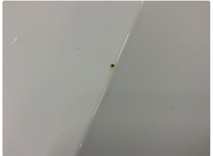
1.1 Noe steinsprut med rust
