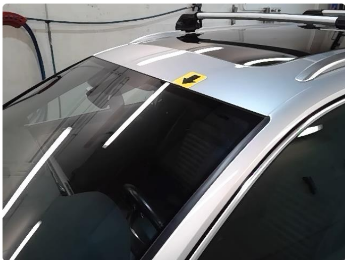
1.4 Steinsprut utenfor synsfelt
