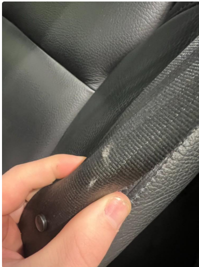
4.4 Skade på belte
