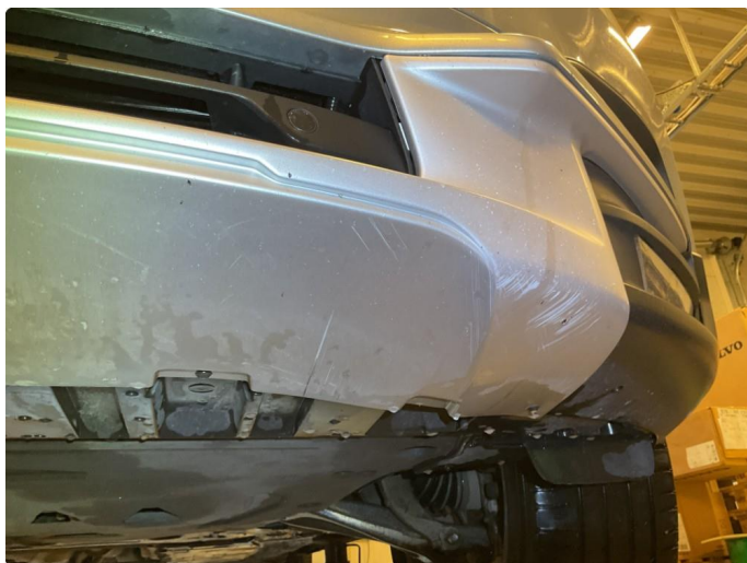
1.6 Noe skrubbskade underkant frontfanger. Fremstår ikke sjenerende
