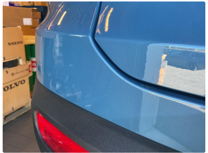
1.5 Noe merkeidr på støtfanger bak. Fremstår som normal slitasje
