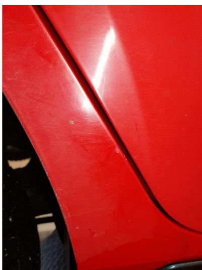
1.7 Steinsprut med rust
