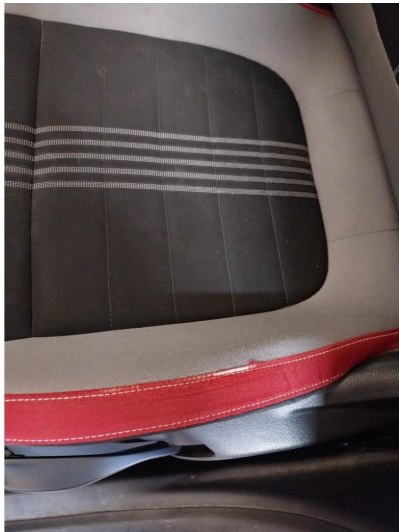
2.1 Skade på setetrekk
