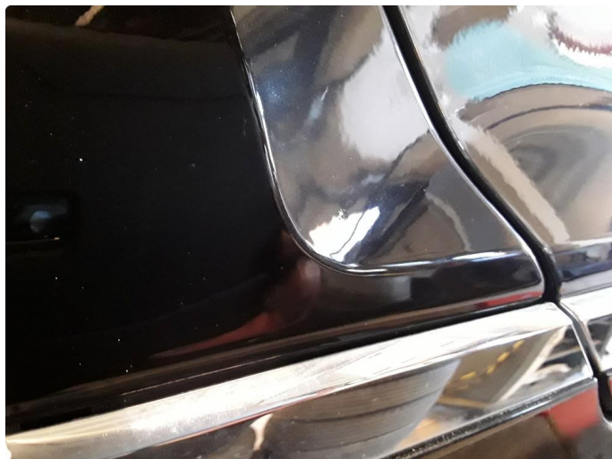
1.4 Liten steinsprut med korrosjon høyre bakskjerm.
