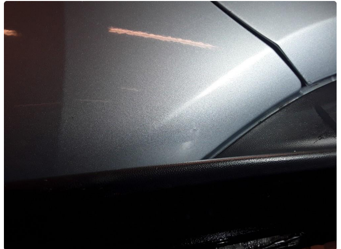
1.5 Liten steinsprut med korrosjon høyre baksjerm.
