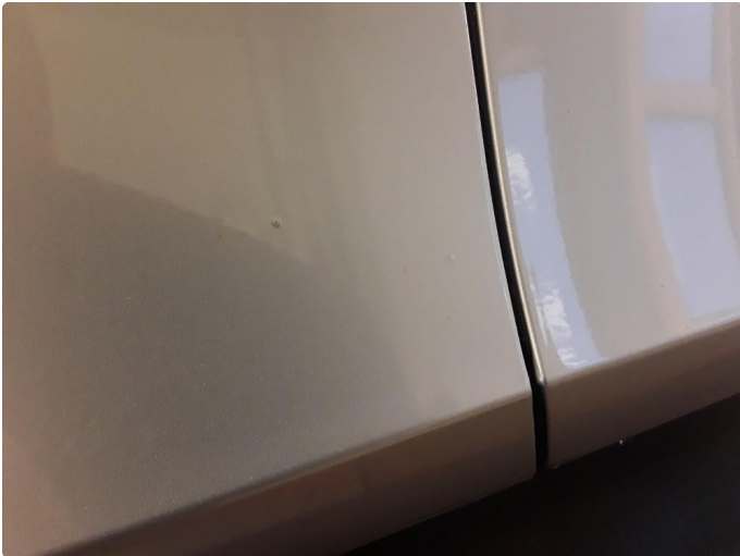
1.2 Liten steinsprut med korrosjon venstre fordør.
