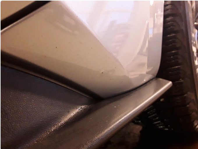
1.4 Liten steinsprut med korrosjon venstre baksjerm.
