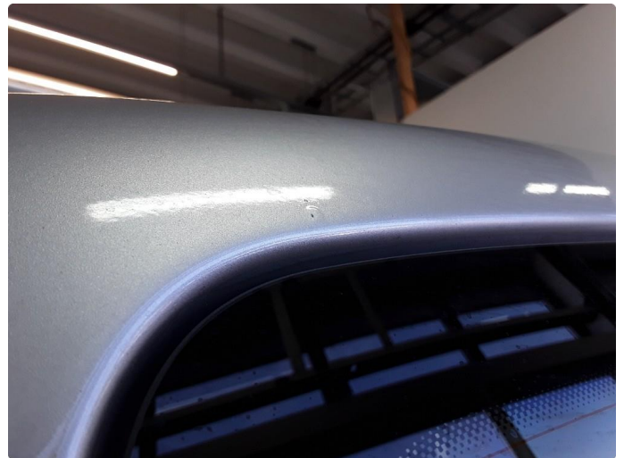
1.3 Noen steinsprut med korrosjon på venstre fløydør.
