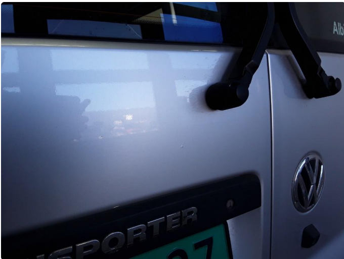
1.3 Noen steinsprut med korrosjon på venstre fløydør.
