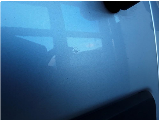
1.3 Noen steinsprut med korrosjon på venstre fløydør.
