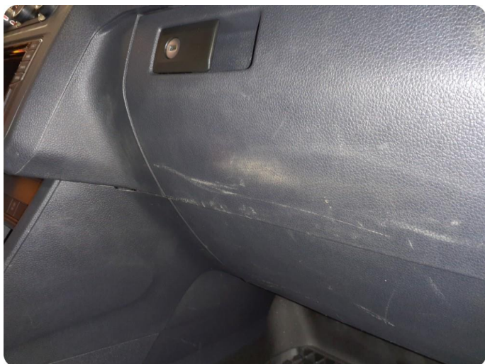
7.2 Øvrige feil Ripper. Interiør inkluderer noe riper, misfarget, merker. Generell bruksslitasje.
