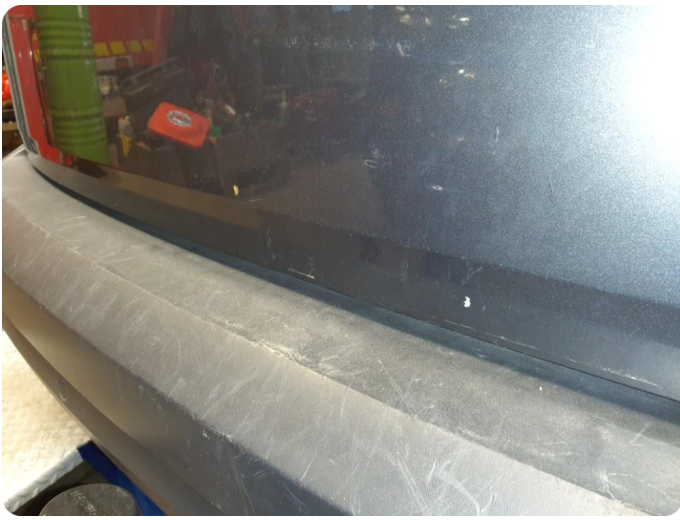
3.1 Øvrige feil Inkluderer riper, småbulker, rust, steinsprut, steinsprut med rust, rester etter folie, lim etter logo mm.
