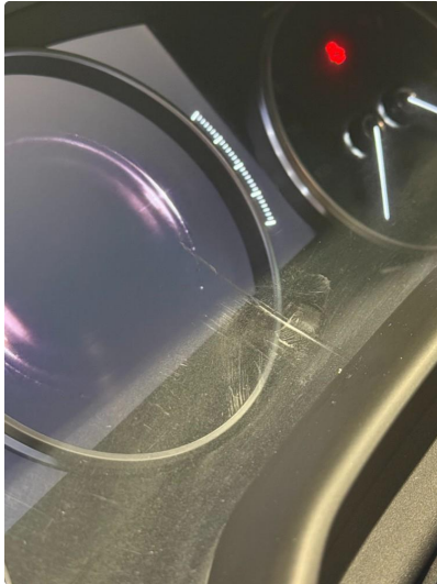
1.1 Sprekk i skjerm
