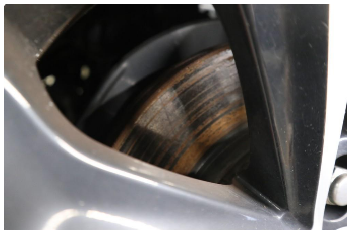
2.1 Noe rust - slites vekk ved kjøring/bremsing
