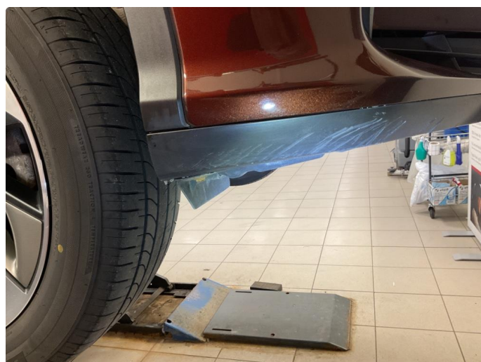
1.2 Skrubbskader underkant av fanger HF
