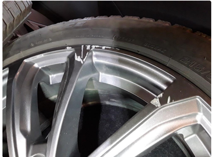
1.3 Noe kantkjørte vinterfelger.
