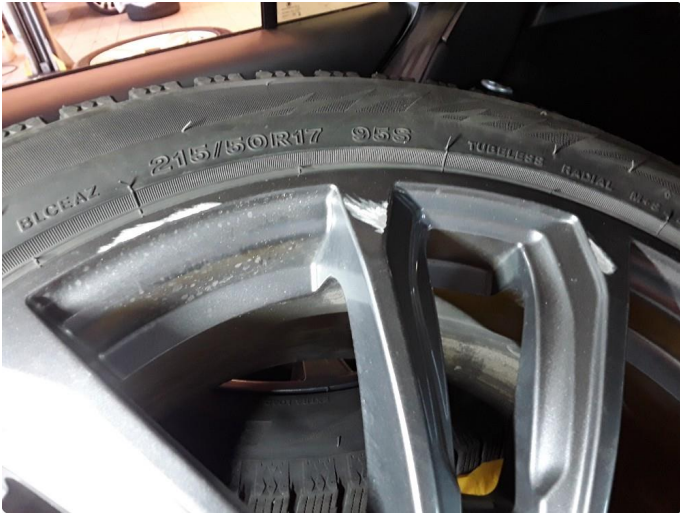
1.3 Noe kantkjørte vinterfelger.
