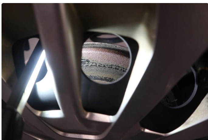
3.1 Mer enn 25% rust
