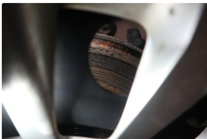
3.1 Mer enn 25% rust
