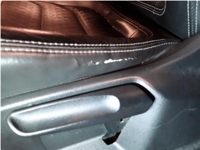
2.1 Skade på setetrekk på førersete
